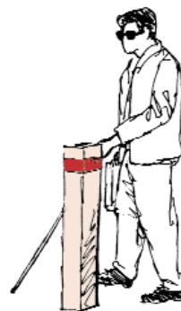
Marquage des poteaux dans le quart supérieur de l'objet
